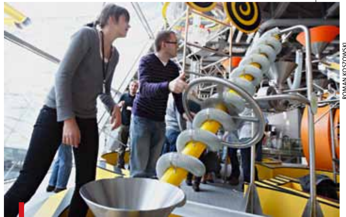
Śruba Archimedes, jedna z pierwszych pomp w historii, w warszawskim Centrum Nauki Kopernik
