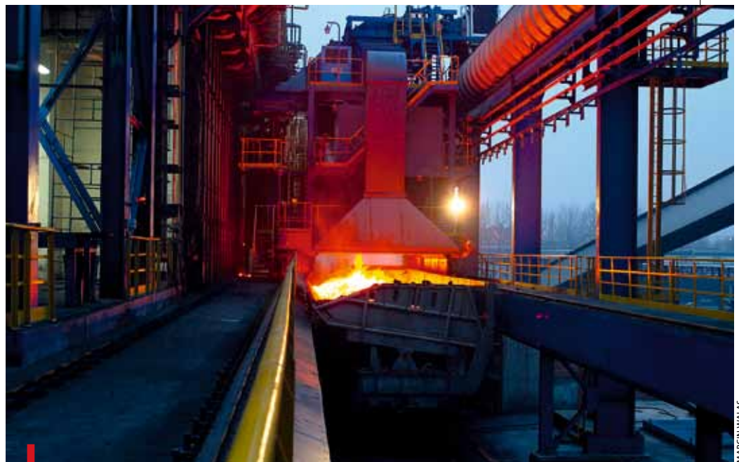
Wóz z rozżarzonym koksem jedzie pod wieżę gaszenia, gdzie zostanie schłodzony wodą PONIŻEJ: Przed laty koks gaszono ręcznie
